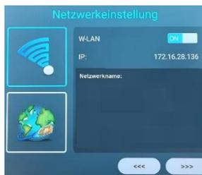
**W-LAN:** In diesem Menü können Sie die W-LAN Funktion Ein- / Ausschalten. **IP:** Hier wird die IP-Adresse angezeigt wenn das Gerät mit einem Netzwerk verbunden ist.
