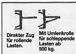
Bei Lasten über 500 kg empfehlen wir die Benutzung einer Umlenkrolle.
