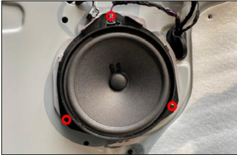
8 Lösen Sie die Schrauben am Lautsprecher.
