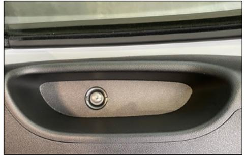
5 Nehmen Sie den Gummieinsatz aus der oberen Ablage der Türverkleidung.
