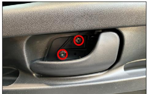
6 Lösen Sie alle Schrauben der Türverkleidung.
