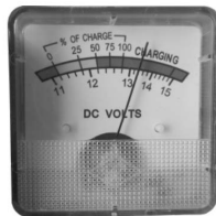
Figure 6 : La batterie est entièrement chargée
