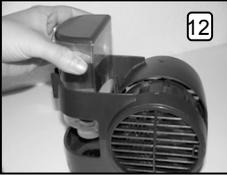
Öffnen Sie den Deckel der Klimaanlage, indem Sie die Lasche an der Vorderseite anheben. Nehmen Sie den Wassertank heraus.
