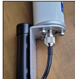
Verwenden Sie dann die beiden Mastklemmen um die Antennenhalterung mit den äußeren Löchern der Antennenhalterung und einem 10-mm-Schlüssel an der Stange zu befestigen. Stellen Sie sicher, dass die Unterlegscheiben verwendet werden und die Schrauben nicht zu fest angezogen sind.
