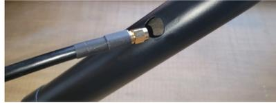
Ziehen Sie das Kabel nach dem Einfädeln durch die Stange und lassen Sie am oberen Ende der Stange genug übrig um die Antenne über den angeschraubten SMA-Stecker anzuschließen.
