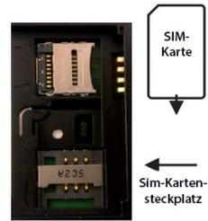
Der größere Steckplatz ist der SIM-Kartensteckplatz. Bitte legen Sie die SIM mit der abgeschnittenen Ecke in die gleiche Position wie auf der Markierung im SIM-Fach mit der Vorderseite nach unten ein. Nachdem die SIM unter der Halteleiste eingelegt wurde, legen Sie den Akku ein und befestigen Sie die Rückplatte (den Deckel) am Router. Stellen Sie vor dem Testen sicher, dass Ihre SIM-Karte mit Guthaben aufgeladen ist.
