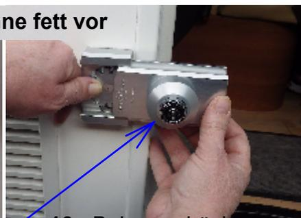
16 - Bei angedrücktem Zahnrad den Schieberegler anbringen, der sich dann automatisch platziert
