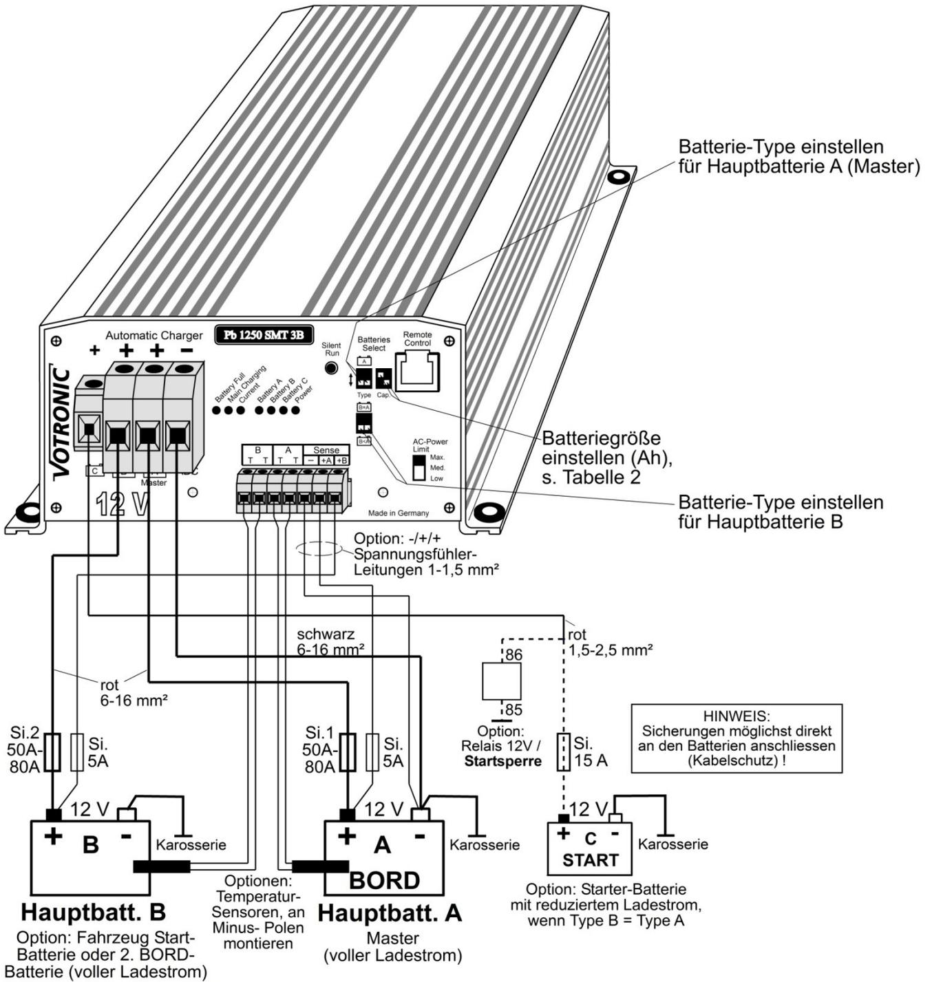
Hinweis: Das Gerät arbeitet aus Sicherheitsgründen bei LiFePO<sub>4</sub>-Batterien **nur** mit angeschlossenem „A“ Temperatursensor (Temperatur-Sensor 825, Art.-Nr. 2001 erforderlich)! Sensor am Minus-Pol der Batterie anschrauben. Empfohlen bei stärkeren Temperaturschwankungen auch für Blei-Batterien!
