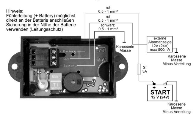
Wird am Alarm-Ausgang ein Verbraucher mit höherer Stromaufnahme als 0,5 A benötigt, so kann dieser mit Hilfe eines zwischengeschalteten Relais geschaltet werden.
